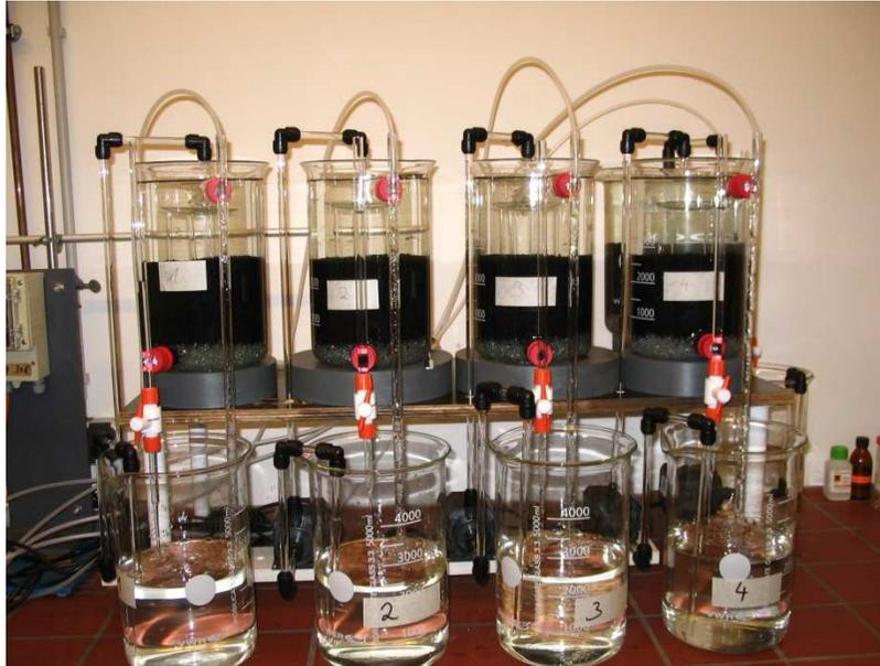
Versuchsaufbau zur Untersuchung biologisch aktiven Filtermaterials
