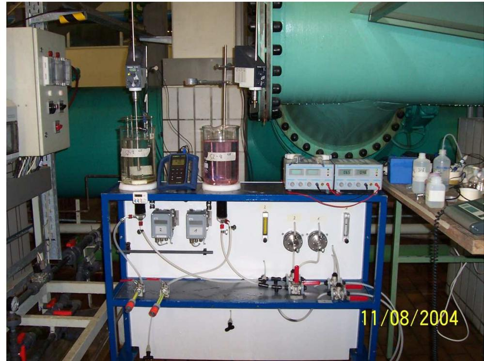
Flockungsversuche im Becherglas mit anschließender Filtration, direkt im Wasserwerk
